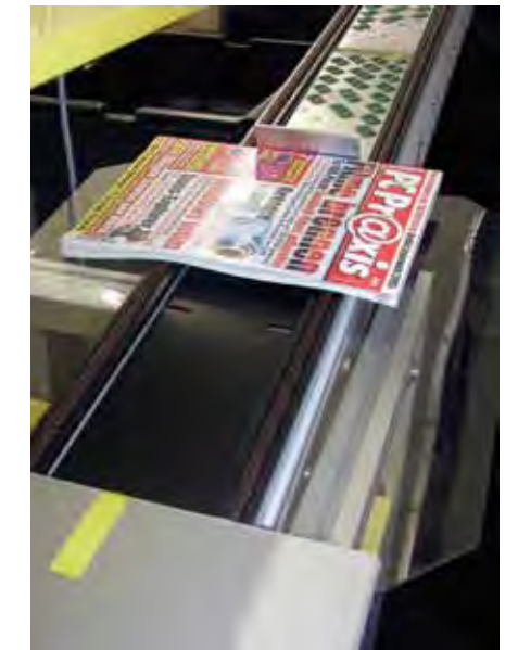
Diese Bilder zeigen das Scannen von oben, den schnellen Abtransport über die beiden geflochtenen Riemen, das Ausschleusen und die „Nicht-erkannt-Schleuse“
