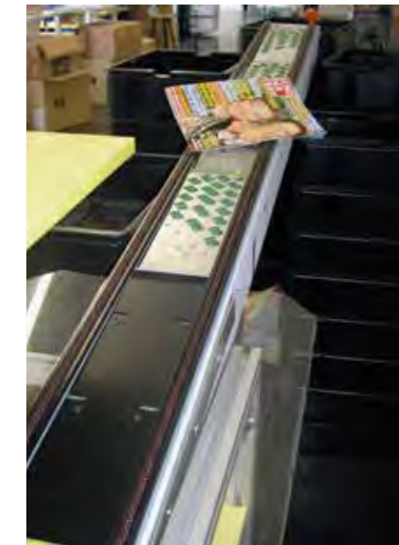
Diese Bilder zeigen das Scannen von oben, den schnellen Abtransport über die beiden geflochtenen Riemen, das Ausschleusen und die „Nicht-erkannt-Schleuse“
