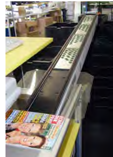
Diese Bilder zeigen das Scannen von oben, den schnellen Abtransport über die beiden geflochtenen Riemen, das Ausschleusen und die „Nicht-erkannt-Schleuse“
