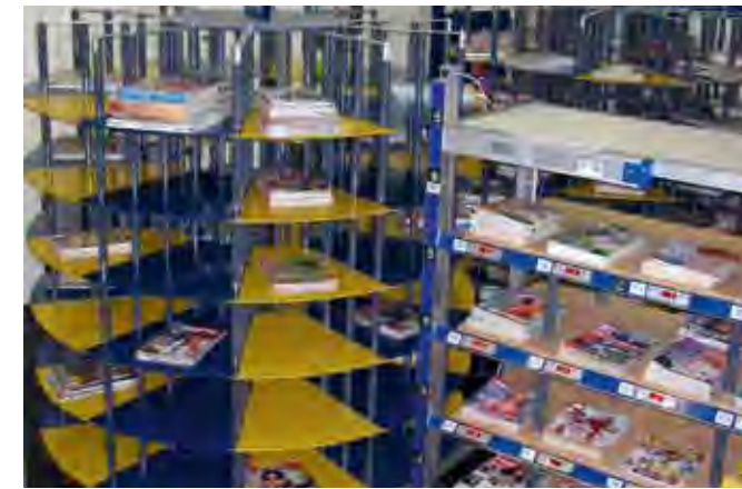
Jedes Fach im runden Fächerturm ist einem Kundenpaket zugeordnet.
