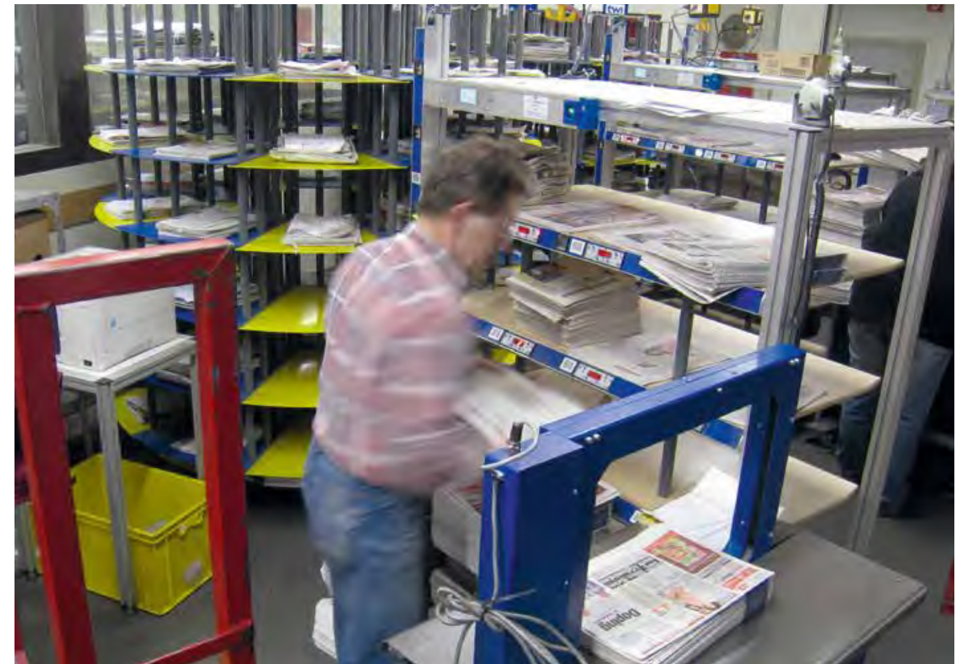
Die Kundenpakete lagern im sich drehenden Turm; die Titel befinden sich im Titelwagen. Das grüne Licht am Quittierungstaster zeigt das richtige Paket an.
