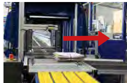
Das Paket mit dem falschen Gewicht wird vom Pusher ausgeschleust.
