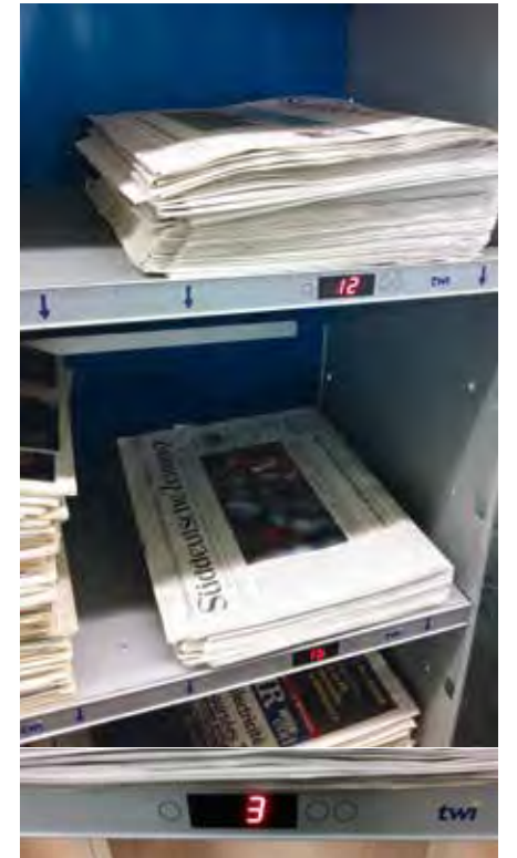
Fachdisplay mit großer LED-Leuchtanzeige und 3 Tastern
